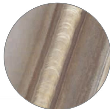
Tupý svar při TIG svařování korozivzdorné oceli AISI 316L o tloušťce 3 mm s použitím plynu Inomaxx® TIG
