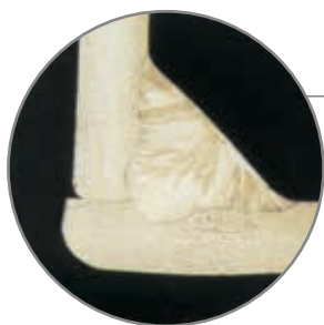
Řez koutovým svarem – MAG svařování korozivzdorné oceli AISI 316L tloušťky 6 mm při použití plynu Inomaxx® 2
